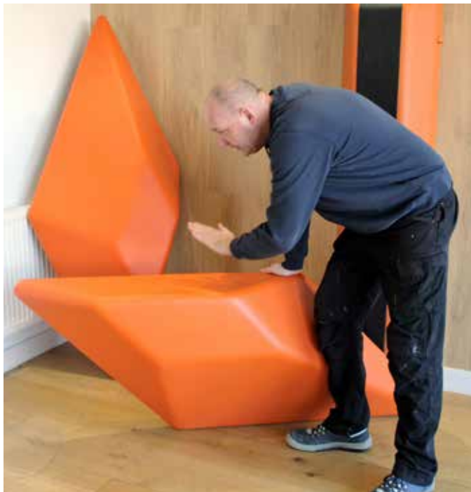
Koos van Bijsterveld toont een voor de Duitse loodsdienst ontwikkelde fender. Deze is halverwege de zijkant van de loodsboot gemonteerd zodat deze hierop kan afdraaien. De platte bovenkant gebruikt de loods als opstapje.
