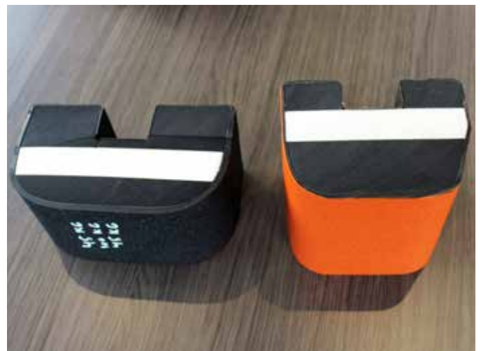
Doorsnede van twee met schuim van verschillende densiteiten gevulde fenders.
