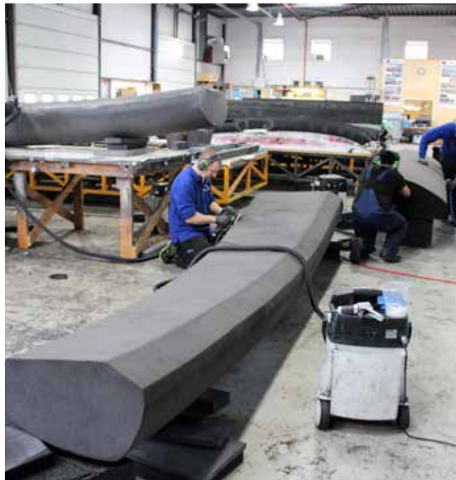
In de productiehal worden fenders voor een Rebel 47 voor botenbouwer SACS gemaakt, een Italiaanse producent van snelle motorboten en tenders voor superjachten. Ze worden met de hand al zo glad afgewerkt dat nafrezen niet meer nodig is. Elke Rebel 47 heeft vier fenders plus een boegdeel. Dit jaar bouwt Fender Innovations veertig sets voor SACS.
